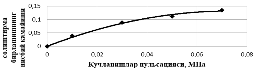
1 – Расм. бархан қумларнинг солиштирма бирлашишнинг нисбий камайиши кўрсаткичларининг кучланишлар пулсацияси катталигига боғлиқлиги: 1 – 1 зичланиш коэффициентида; 2 – 0.95 зичланиш коэффициентида; 3 – 0.9 зичланиш коэффициентида
