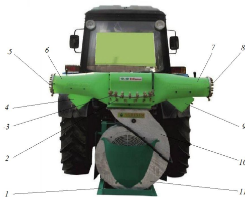
Рис.1. Универсальный опрыскиватель для обработки полевых и садовых культур на основе управляемых воздушно-капельных потоков
