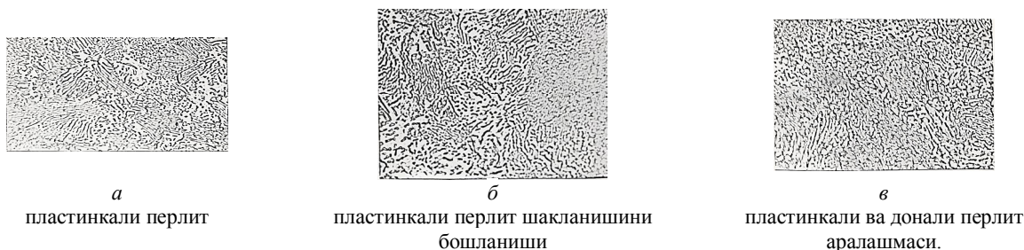
2-расм. 65Г маркали пўлатнинг 450 °C ҳароратда циклик қиздирилган ва ҳаво билан совитилгандан кейинги микроструктураси ( \times 1000 ): а) 3-циклда қиздириш; б) 5-циклда қиздириш; в) 6-циклда қиздириш
