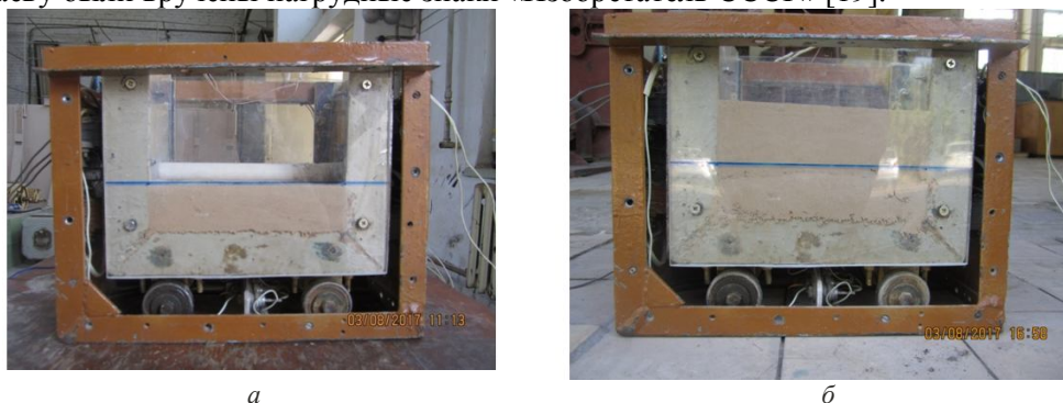
Рис. 2. Установка по воспроизведению управляемых динамических воздействий в каретке центрифуги: а – общий вид платформы; б – засыпанная грунтом в 3.0 см
